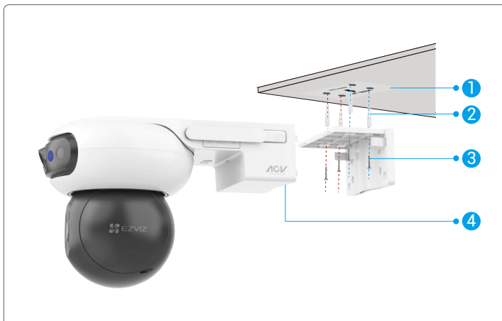
Εικ. 1 Τοποθέτηση στην οροφή
